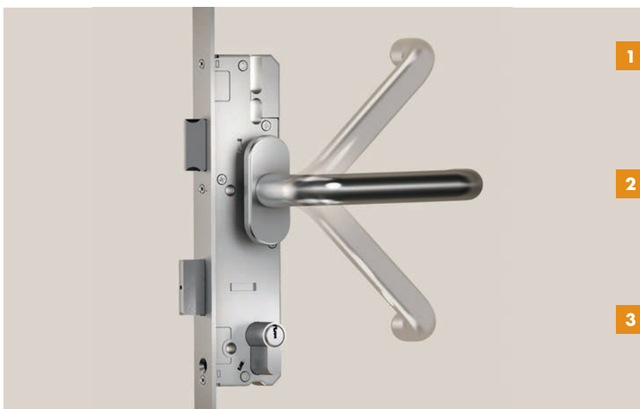
COMANDO SULLA MANIGLIA: APERTURA E CHIUSURA DALL'INTERNO CON MANIGLIA: 1 CHIUSURA, 2 POSIZIONE DI RIPOSO, 3 APERTURA, BLOCCO MANIGLIA CON CHIAVE.
